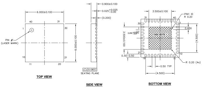
Figure 31. 40-Pin Pb-free Sawn-QFN 6 ×6 mm
